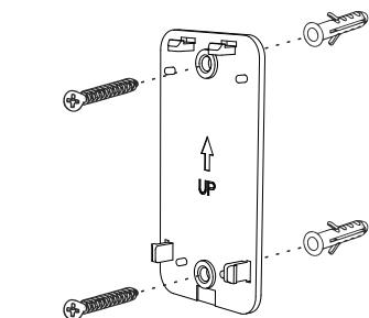
用螺丝安装，将底壳钉入墙壁
