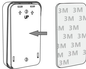
将3M双面胶贴在发射器背面
