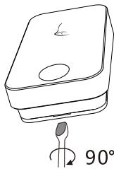
用螺丝刀拆卸发射器的底壳
