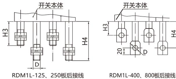
图11 RDM1L系列板后接线外形及安装尺寸
