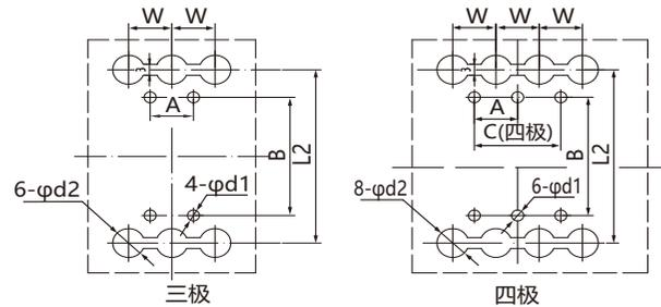
图12 RDM1L系列板后接线安装板开孔尺寸
