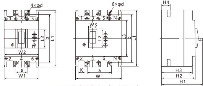
图10 断路器外形尺寸和安装尺寸
