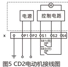
图5 CD2电动机接线图
