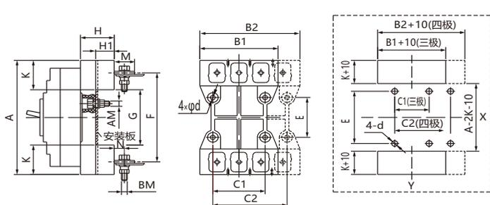
图13 插入式板后安装板开孔尺寸
