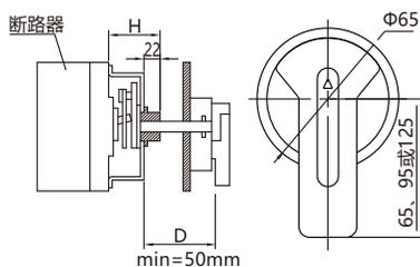
图6 手动操作机构安装尺寸图
